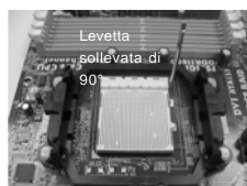
FASE 1: Sollevare la levetta socket
