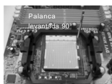
PASO 1: Levante la Palanca del Zócalo
